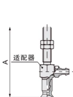
安装方式: 外螺纹
