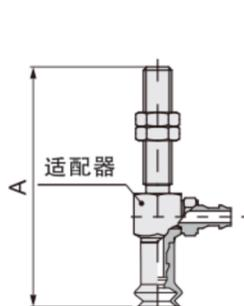
安装方式: 外螺纹
